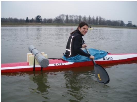
L'engin est constitué de 2 supports, d'un tube PVC de 125mm de diamètre fermé aux 2 extrémités dans lequel se trouve entre 1 et 6 litre d'eau. Le tout est maintenu sur le pont du bateau par une sangle qui passe sous le bateau.
